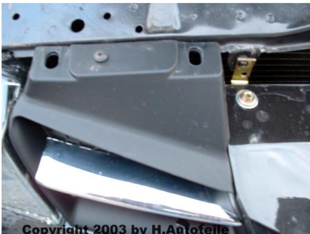
Scheinwerferblende mittels einer Keuzschlitzschraube montiert.
