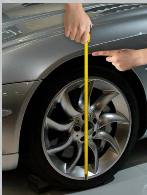
Corretto sistema di misurazione dell'assetto, PRIMA e DOPO l'intervento / Correct system of measuring the suspension levelling, BEFORE and AFTER
