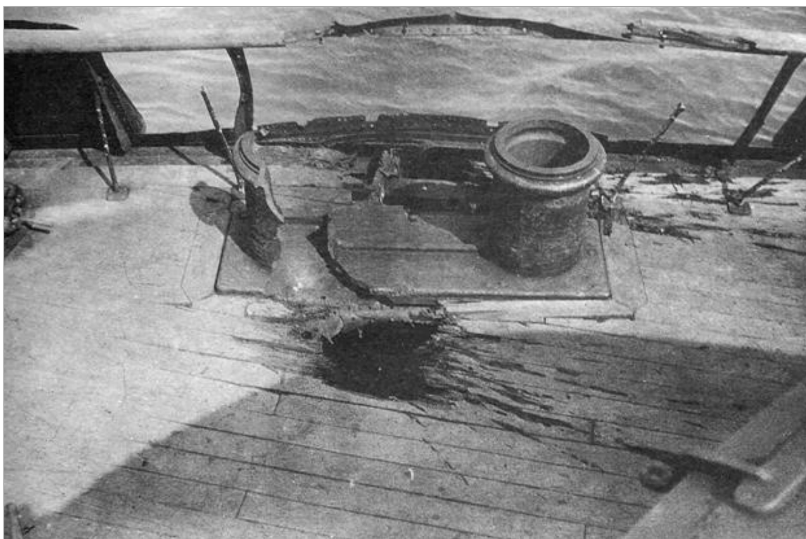
Рис. 66. Повреждения юта. Левый борт. Видна конструкция внутренней части фальшборта. На переднем плане кнехт, разбитый японским снарядом. Отсутствуют сорванные взрывом заглушки в верхней части кнехта. Обращает на себя внимание деревянная подушка кнехта и палубный настил.
