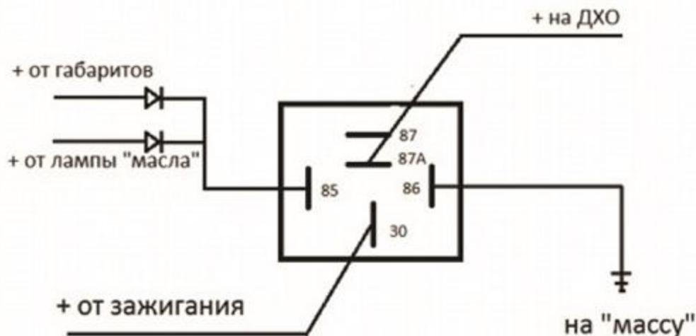
Обычно реле имеет 5 контактов (бывают и 4-хконтактные и 7-ми и т.д.).
