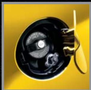
○ A bordo di MiTo GPL Turbo 120 CV il bocchettone per il rifornimento è di fianco a quello per la benzina, facilmente accessibile ed utilizzabile.
